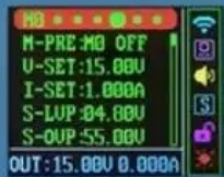
Power parameter setting interface
