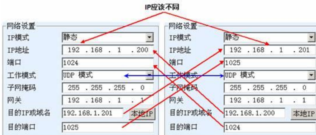
picture21 UDPDevice couplet parameter configuration
