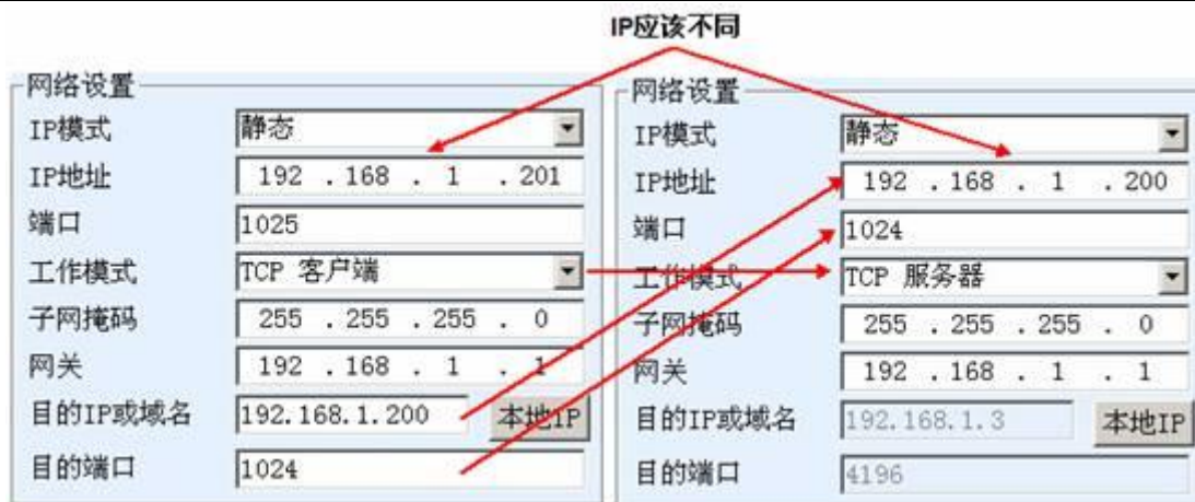
picture19 TCPDevice couplet parameter configuration
